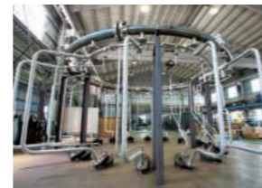
▲ マニホールド (燃料分配配管)
