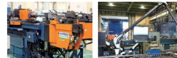
▲CNCパイプベンダー ▲三次元測定(非接触式)
