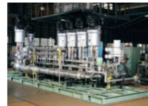
▲ 燃料ガス流量調整ユニット
