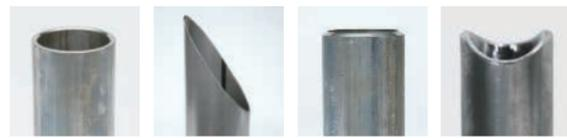
▲直角切断 ▲斜め切断 ▲開先 ▲鞍型
