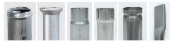
▲ピーディング ▲Wフレア ▲縮管 ▲拡管 ▲スピニング ▲つぶし
