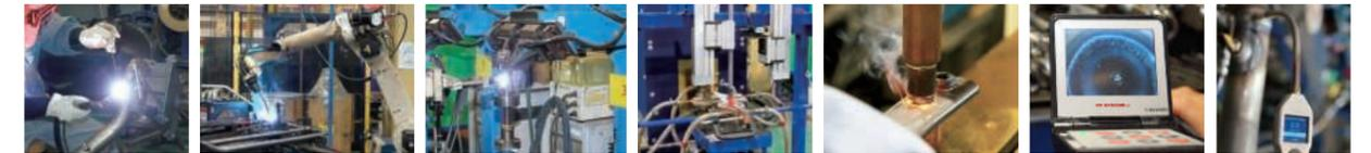
▲TIG溶接 ▲MAG溶接 ▲パルスTIG溶接 ▲高周波ロウ付 ▲プロジェクション溶接 ▲内視鏡検査 ▲水素漏れ検査
