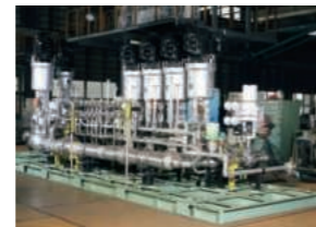
▲ 燃料燃气流量调整机组
