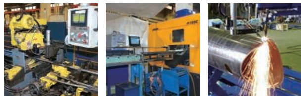
▲自动圆锯切割机 ▲超硬圆锯切割机 ▲配管空气等离子切割机
