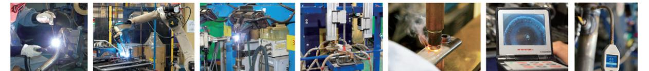
▲TIG焊接 ▲MAG焊接 ▲脉冲TIG焊接 ▲高周波焊接 ▲凸焊 ▲内视镜检查 ▲氢气泄漏检查
