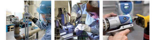
▲组装作业 ▲夹具组装作业 ▲三次元测量（接触式）
