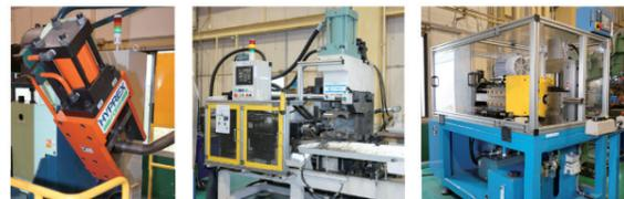
▲压力机 ▲终端加工机 ▲强力旋压加工机
