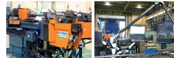
▲CNC弯管机 ▲三次元测定（非接触式）
